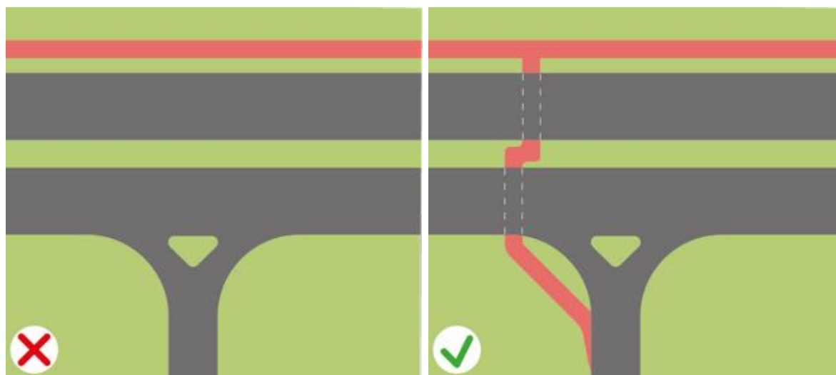
Figura 19 :Esquemas comparam via lateral não acessível e via lateral acessível, para pedestres e bicicletas
