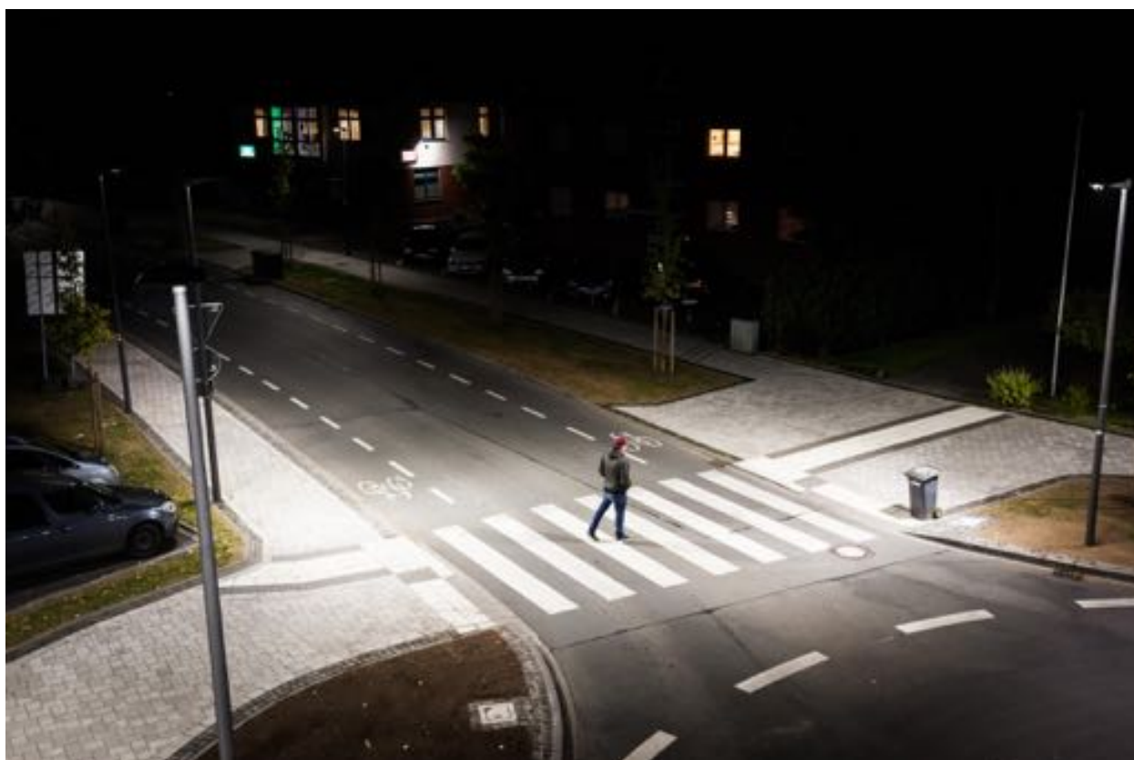
Figura 10: Iluminação em travessias: percebe-se pela imagem que há luzes direcionadas especialmente para a travessia de pedestres. Dalbrück, Alemanha. Fonte: Internet, s.n.t.
