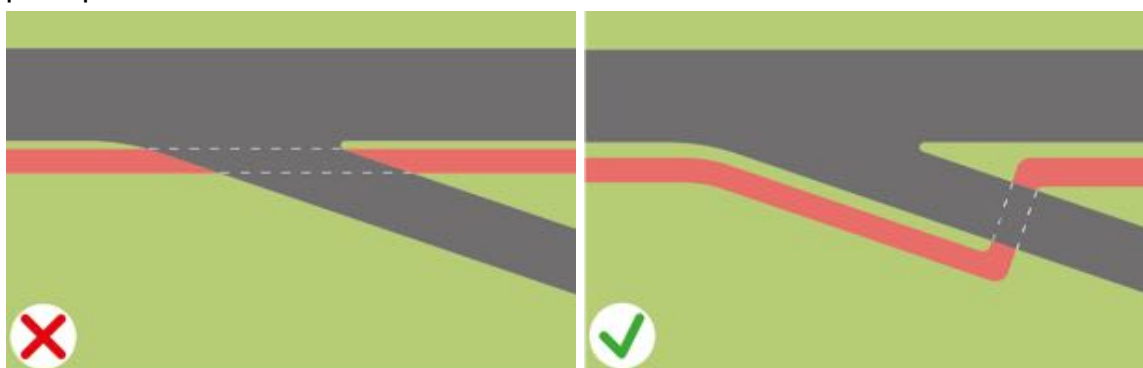
Figura 13: Posicionamento da travessia nas saídas de uma rodovia. O correto é fazer ela afastada da via principal, como ocorre na imagem da direita. Fonte: Cicloiguaçu, 2019.
