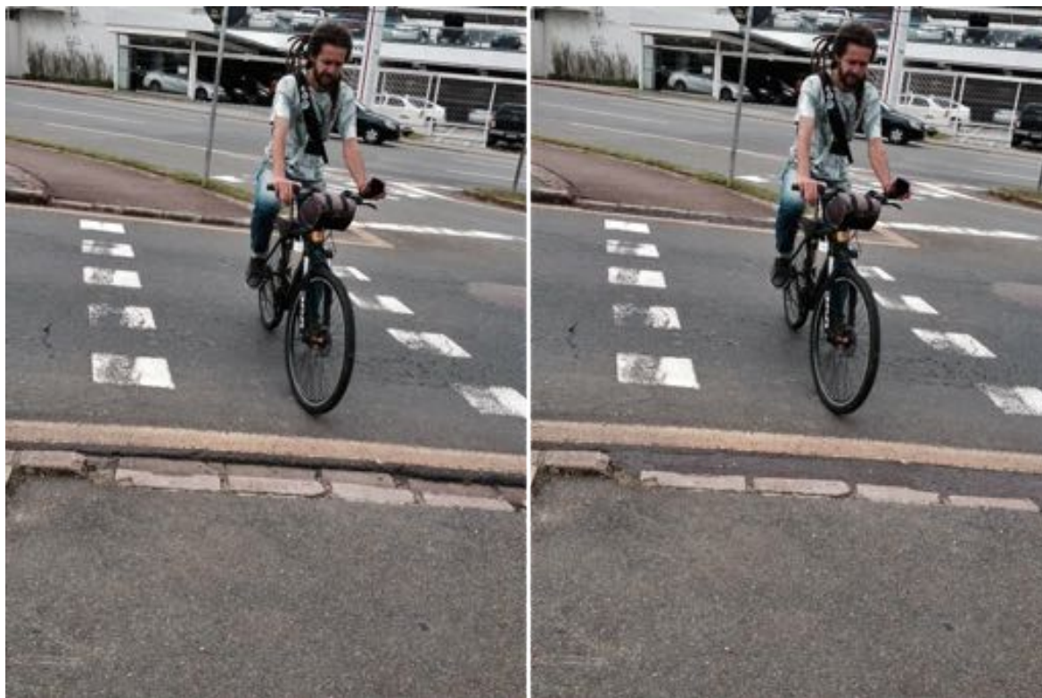
Figura 21: Situação comum (esq.): guia-rebaixada com degrau acentuado. Fotomontagem (dir.): acesso readequado com preenchimento em CBUQ. Fonte: Cicloiguaçu (2015) 14
