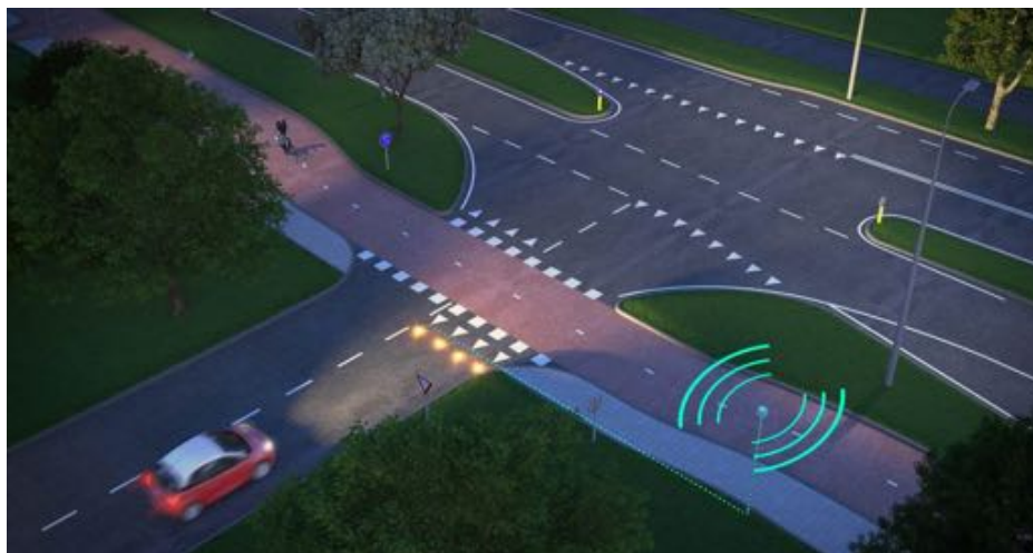
Figura 9: Exemplos de sinais luminosos piscantes BikeScout, acionados pela detecção de ciclistas. Fonte: Heijmans (Países Baixos).
